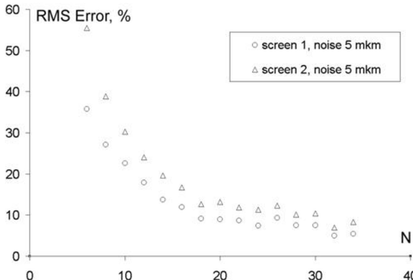
**Среднеквадратичная ошибка восстановления фазовой функции в зависимости от количества субапертур датчика Шака-Гартмана на диаметр пучка ( $N \times N$ )**
